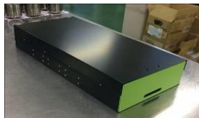
蓄電池モジュール (10セル)
