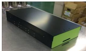
蓄電池モジュール (10セル)
